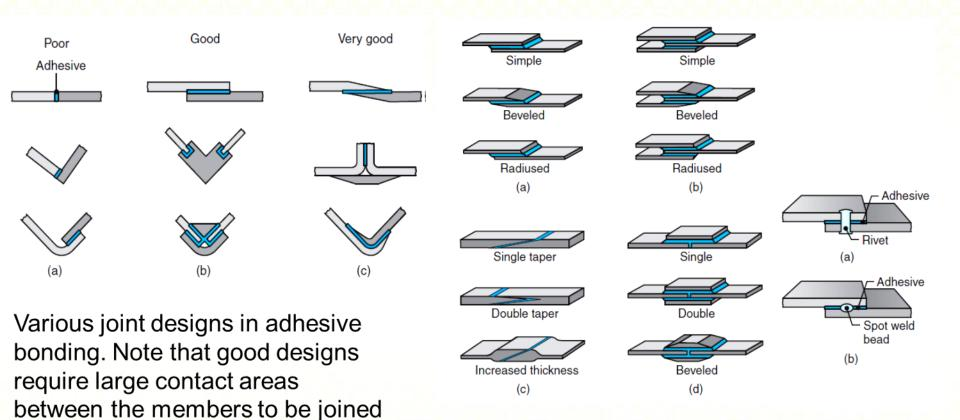
(a) single lap, (b) double lap, (c) scarf, and (d) strap
