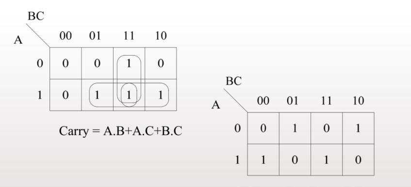
$Sum = \overline{A}.\overline{B}.C + \overline{A}.B.\overline{C} + A.\overline{B}.\overline{C} + A.B.C$
